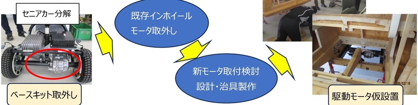
インホイールモータと違い後輪車軸中心に新設モータを設置しなければならない、さらに走行に耐えうる強度が必要なため、スペース確保と強固な治具を製作し設置まで完了。
